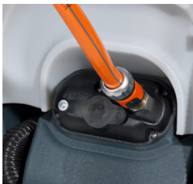
Vattenpåfyllningssystem med snabbkoppling och automatisk brytare när tanken är full (tillbehör).
